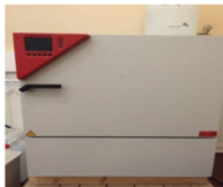
Chamber sebagai alat bantu kalibrasi Termohigrometer
