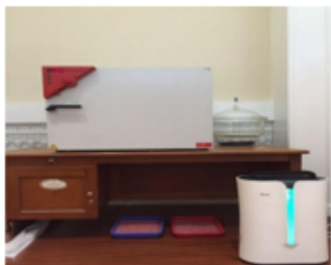
Oven sebagai alat bantu kalibrasi Meter Kadar Air
